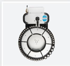
**Cargue sus muestras y pulse el botón START.** La bandeja gira y el brazo con aguja queda alineado en la parte superior del primer vial con la muestra a procesar.
