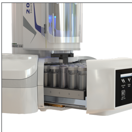
Controllo presenza vial
